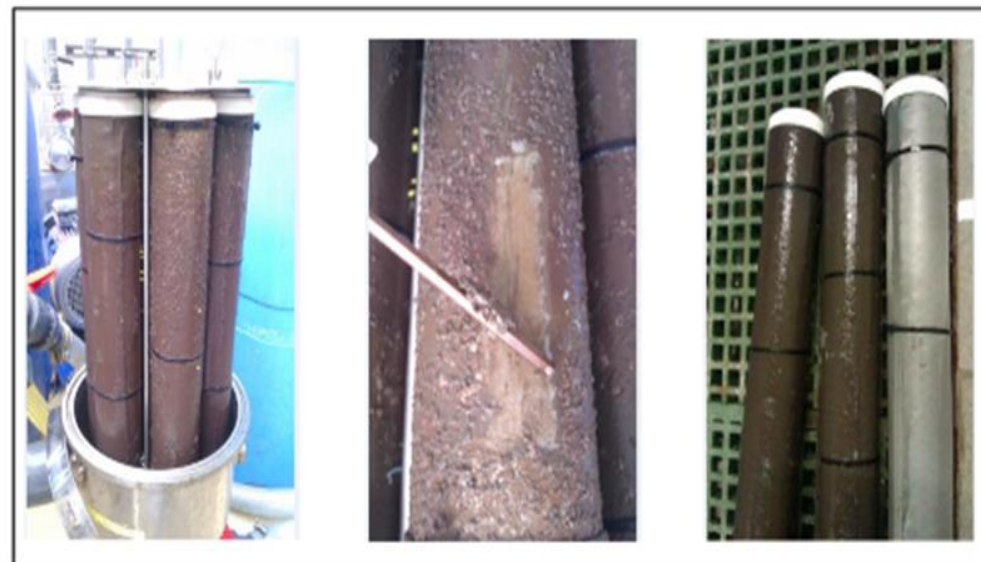
Fig. 2.2.2.3.3. Filtri a cartucce dell'impianto pilota dopo 13 giorni di utilizzo di acido acetico come agente neutralizzante. Nell'ultima illustrazione, parallelo con filtro nuovo.
